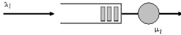
Figura 2.1: Representação esquemática de um sistema de fila única, com chegadas a uma taxa \lambda_i e serviço a uma taxa \mu_i .
