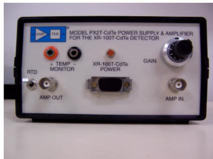
FIGURA 9- Amplificador e fonte de alimentação PX2T CdTe
