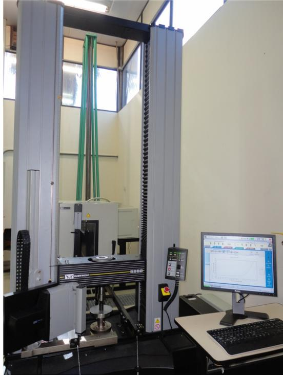
FIGURA 3- Máquina Universal Instron 5882 - 100kN
