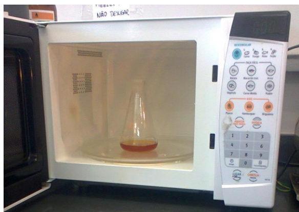
Figura 32 - Forno de micro-ondas utilizado na reação de transesterificação.
