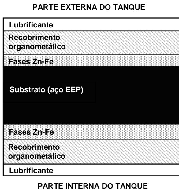
FIGURA 2 Esquema do aço EEP galvanizado, com recobrimento organometálico e lubrificante em ambas as faces.
