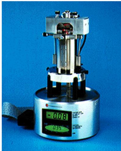
Figura 6.2 : Multimode III- A Microscópio usado nas medidas de AFM
