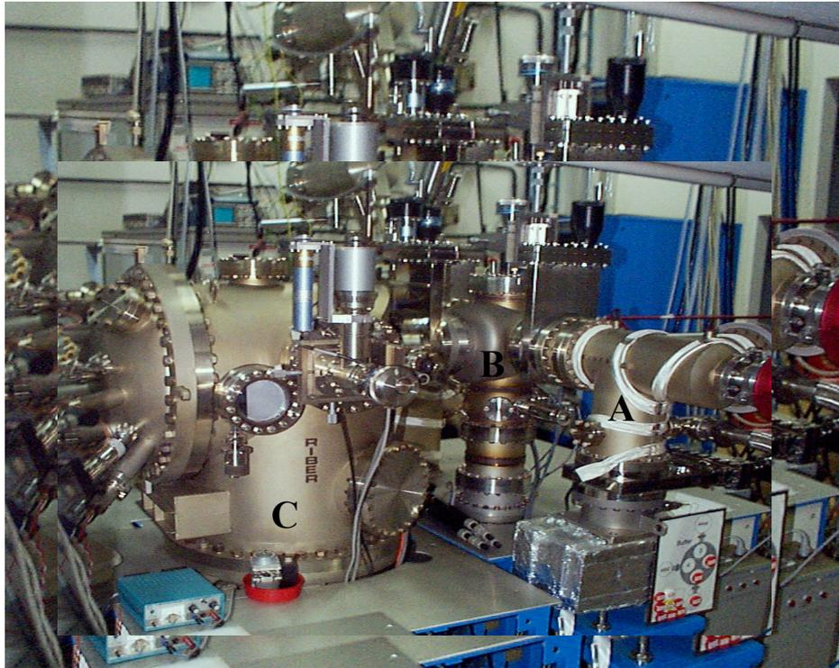
Fig. 3.3- Sistema *Riber* de MBE utilizado no crescimento das amostras. A câmara E-E, B câmara *buffer*, e C câmara de crescimento.
