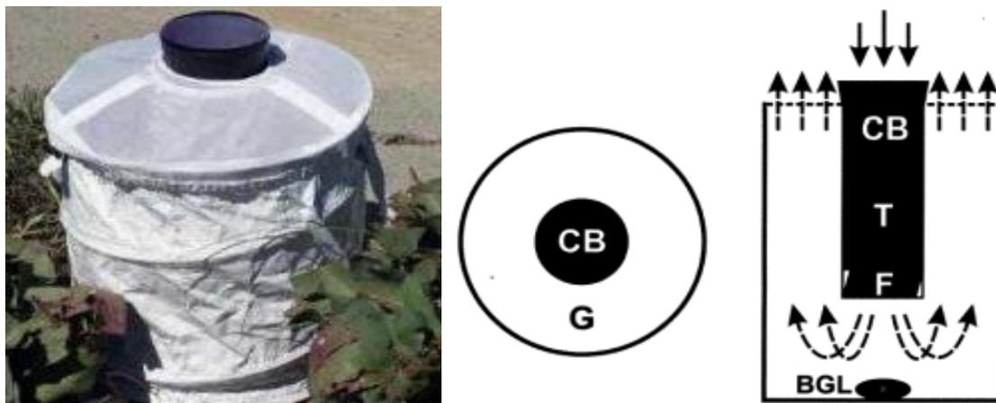
Figura 14. Armadilha BG-Sentinel: (A) Foto, (B) Desenho esquemático da armadilha. G = Malha de cobertura; CB = Funil de entrada; T = Tubo preto; F= Ventilador de 12 V; BGL = Atraente sintético. Setas indicam o fluxo de ar
