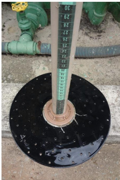
FIGURA 4.6: Equipamento para a medição da altura do lodo e esquema representativo das hastes milimetradas e do disco perfurado.
