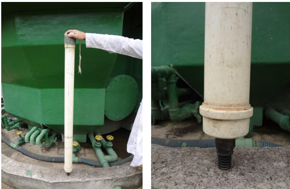
FIGURA 4.3: Coletor utilizado para amostragem da coluna líquida da lagoa.
