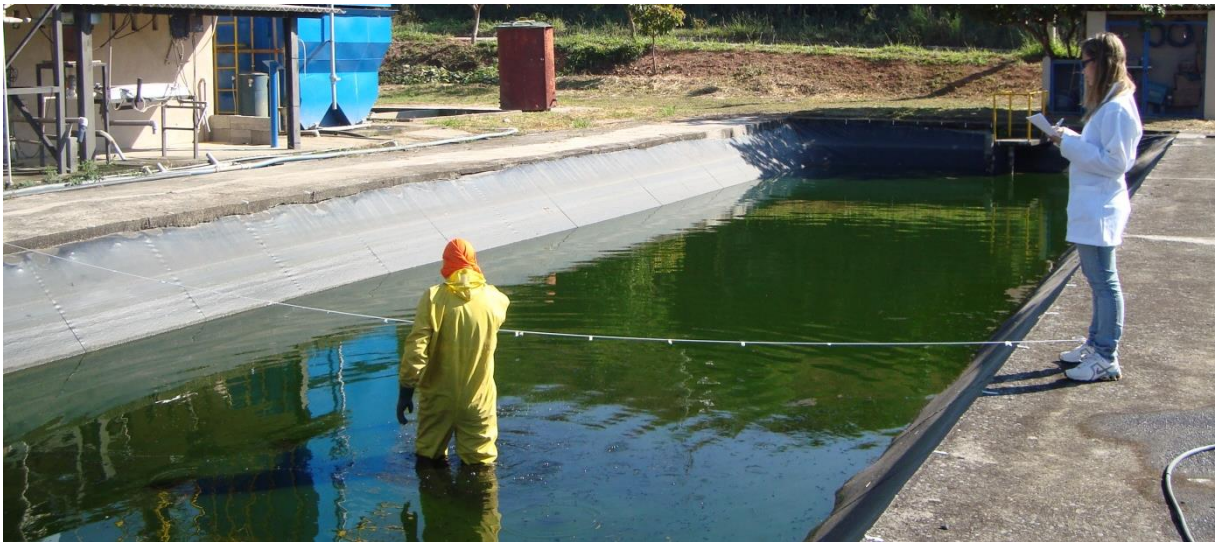
FIGURA 4.5: Batimetria das lagoas de polimento, acesso a pé e demarcação por piqueteamento.
