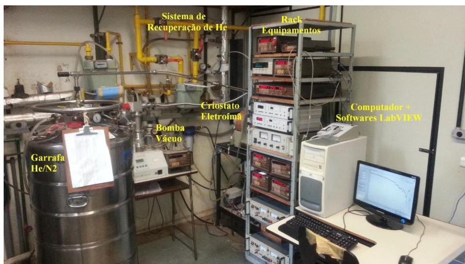
Figura 7.1 Infraestrutura do Laboratório de Transporte do Dep. Física da UFMG.
