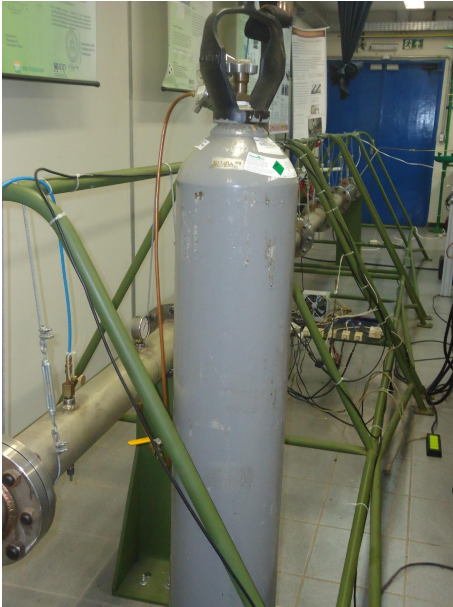
Figura 4.26 - Tubo de Choque com cilindro de nitrogênio acoplado.
