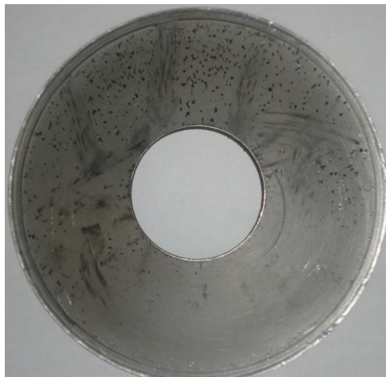
Figura 4.29 – Resíduos de fuligem após teste com combustão.
