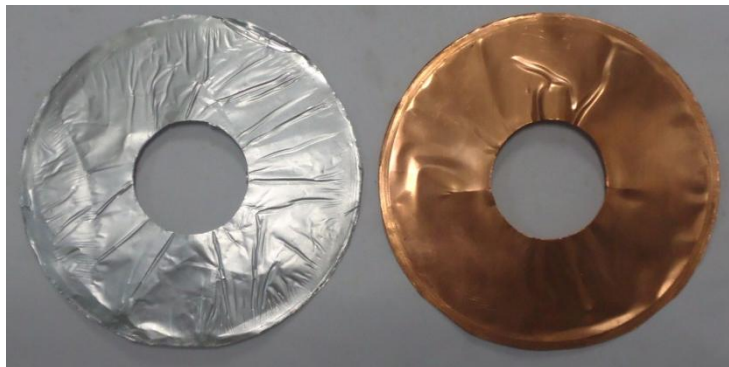
Figura 4.17 - Membranas de alumínio e cobre antes do teste no Tubo de Choque.
