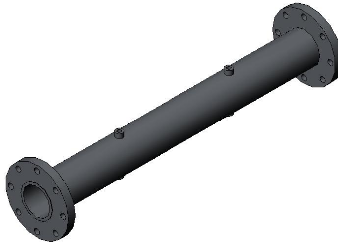
Figura 4.4 - Vista dos orifícios de instrumentação do Tubo de Choque.
