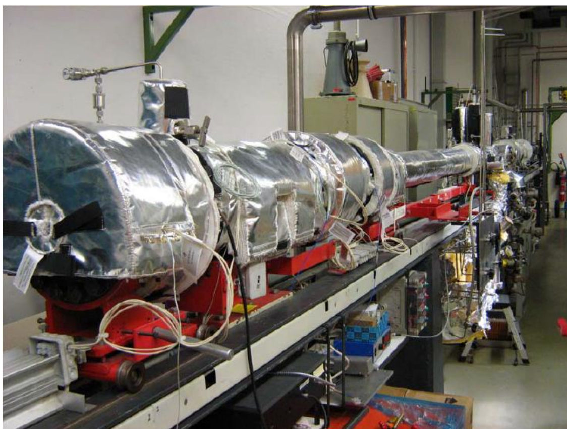
Figura 3.12 - Fotografia do Tubo de Choque de Duisburg Essen.
