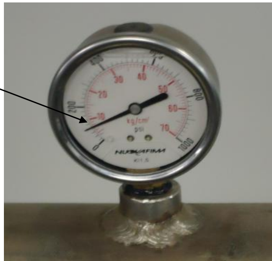
Figura 4.12 - Teste de vedação do Tubo de Choque.
