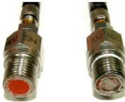
Figura 3.21 - Tradutores de pressão com e sem revestimento Silicone
