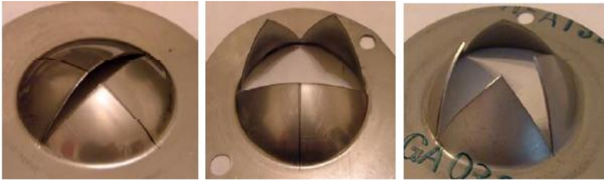
Figura 3.19 - Membranas utilizadas por McMillan nos testes no Tubo de Choque.
