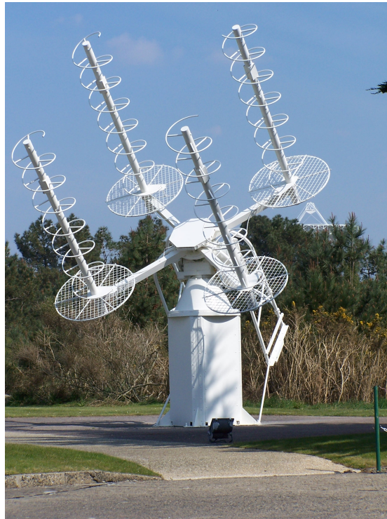
Figura 1.1 Conjunto de antenas helicoidais utilizado em rastreamento de satélites.
