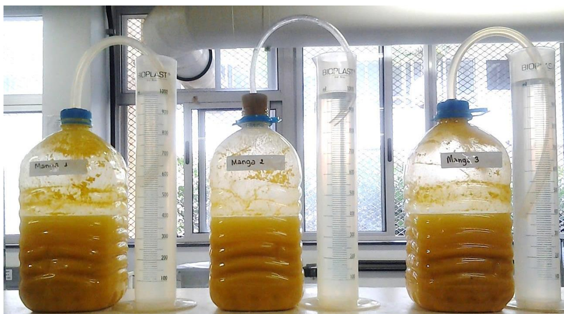
Figura 9. Modelo de fermentador utilizado. Bombonas tipo PET dotadas de mecanismo para a liberação de CO 2
