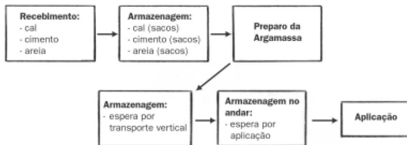
Figura 2.1: Fluxograma para argamassa produzida em obra Fonte: ABCP, 2013a, p. s.p.
