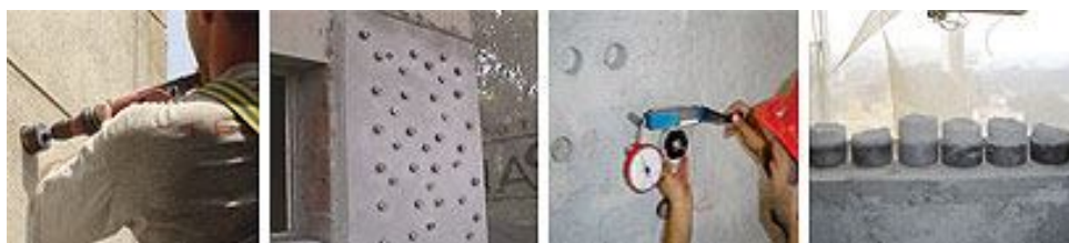
Figura 3.1: Teste de Resistência de Aderência à Tração ( R_a ) passo a passo Fonte: Nakamura, 2013, s.p.
