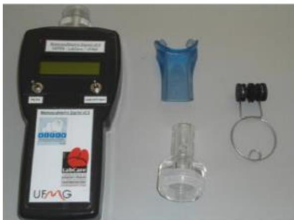
Legenda: Manovacômetro digital com peça acrílica, bocal do tipo mergulhador e clipe nasal.
