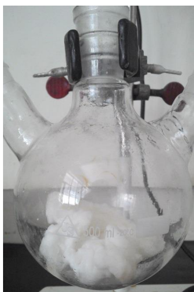
Figura 5.1: Produto da reação de formação de PU utilizando-se etileno diamina.
