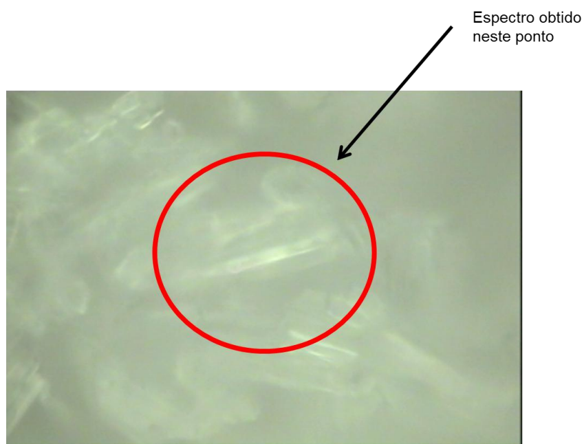
Figura A.3: Imagem da superfície do sólido precipitado no licor sintético sulfúrico (aumento 50x).
