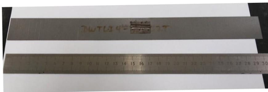
Figura 4.2 - Amostra "cobaia" com uma presilha soldada para inserção do termopar.
