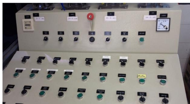
**Figura 53:** Controle manual de dosagem do CAA (Fonte: Supermix – Belo Horizonte)
