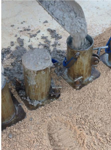
**Figura 48:** Moldagem dos corpos de prova (Fonte: QRTZ Incorporações – Belo Horizonte)
