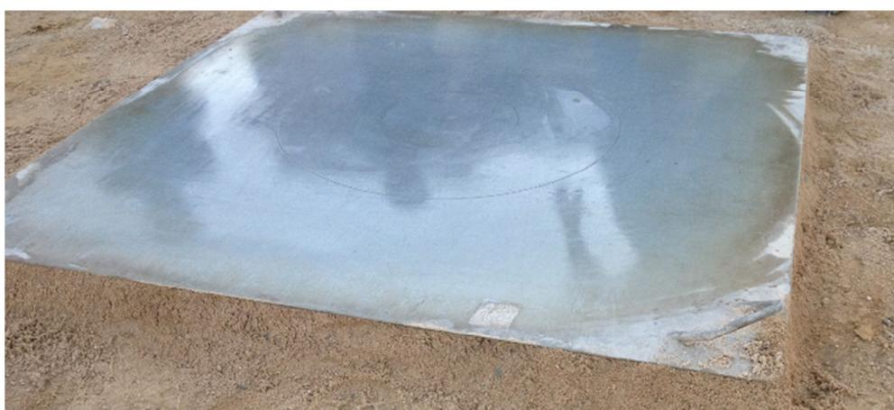
**Figura 44:** Base para espalhamento do CAA no ensaio Slump Flow Test (Fonte: QRTZ Incorporações – Belo Horizonte)
