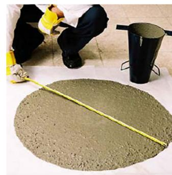
**Figura 7:** Medição do espalhamento do CAA (RILEM, 2006)
