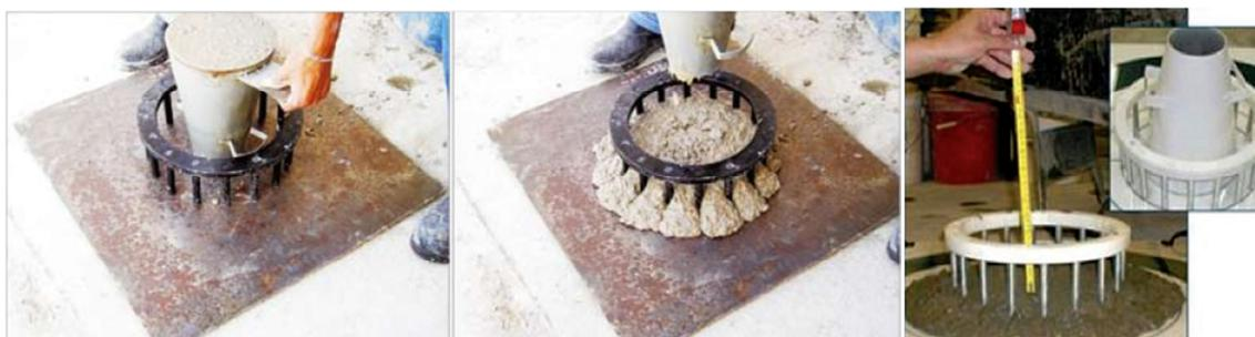
**Figura 13:** Ensaio do Anel J (Fonte: Revista Concreto & Construções, 2008)
