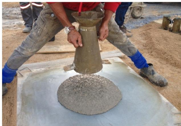
**Figura 56:** Espalhamento do CAA no ensaio Slump Flow Test (Fonte: QRTZ Incorporações – Belo Horizonte)
