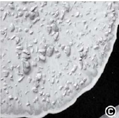
**Figura 10:** Leve exsudação de água, observada na beira do concreto (Fonte: Revista Concreto & Construções, 2008)
