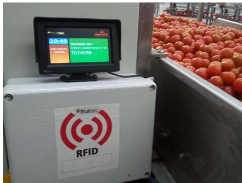
Figura 19: Esteira com leitor de etiquetas RFID para frutas e legumes Fonte: da pesquisa, 2014.
