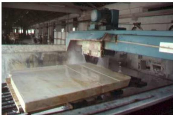
**Figura 45** – Lavra mecânica de rocha: máquina de corte computadorizada (várias placas podem ser simultaneamente cortadas; o corte é processado de forma a aproveitar a maior área possível da rocha (MOREIRA, 2009)
