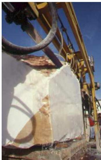
**Figura 44** – Corte de uma placa a partir de um bloco de rocha (MOREIRA, 2009)
