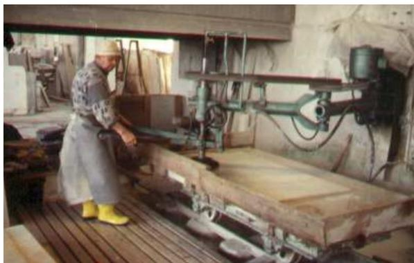
**Figura 46** – Lavra mecânica – disco de abrasão para polimento (MOREIRA, 2009)
