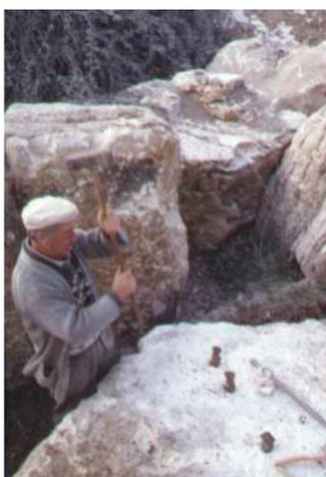
**Figura 42** – Fracionamento de blocos através da introdução de cunhas (MOREIRA, 2009)
