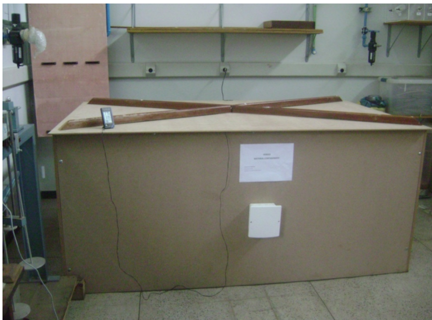
FIGURA 4.12 – Vista da estufa utilizada nos ensaios de durabilidade da geomembrana.
