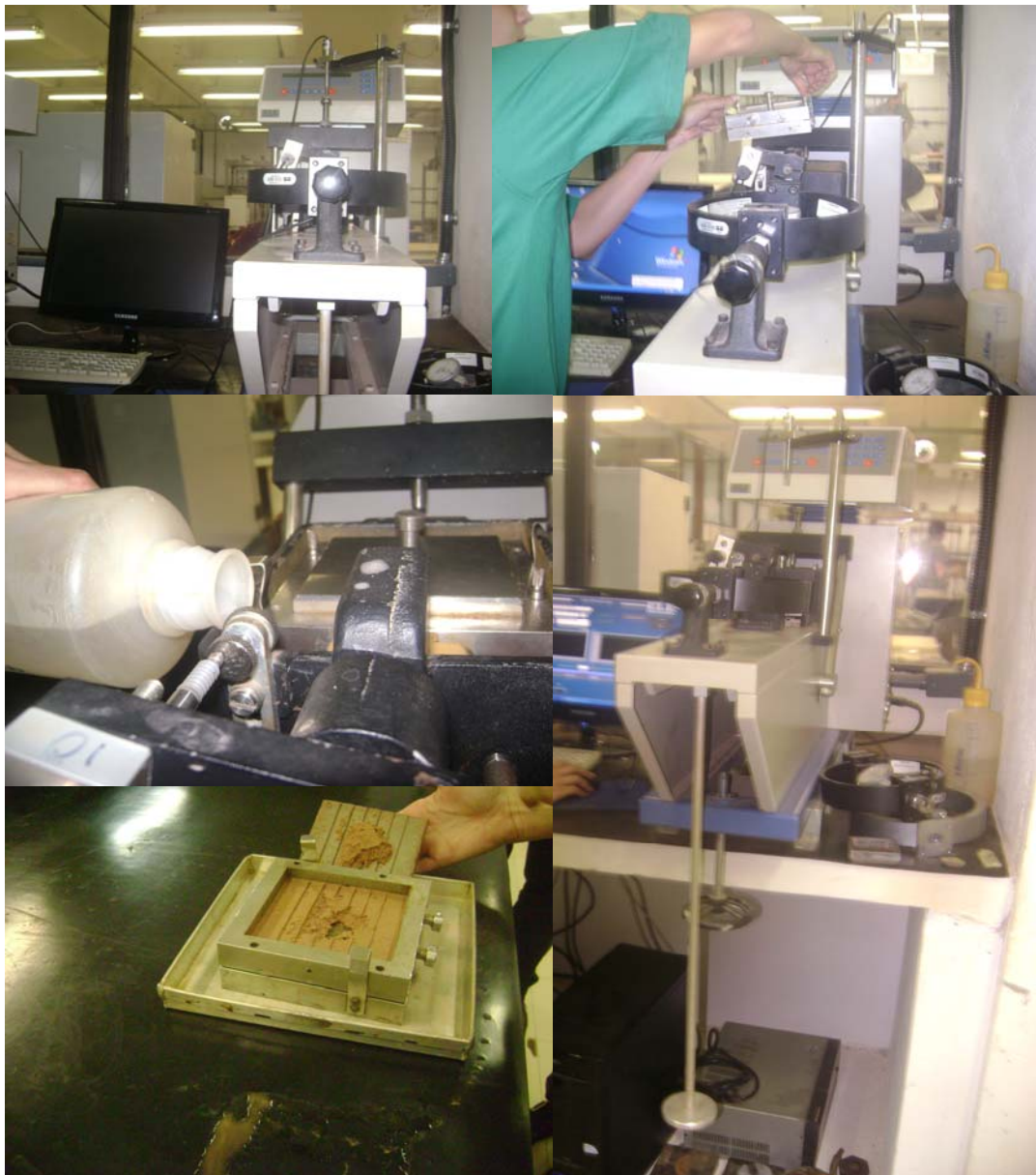
FIGURA 4.6 – Ensaio de cisalhamento direto.
