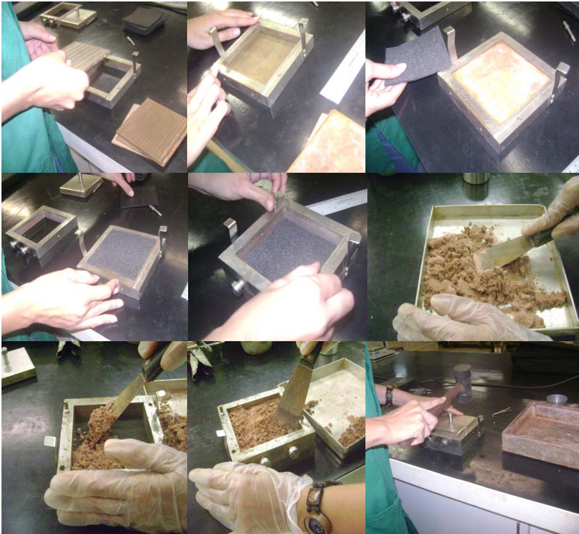
FIGURA 4.5 – Preparação da amostra do ensaio de cisalhamento direto.
