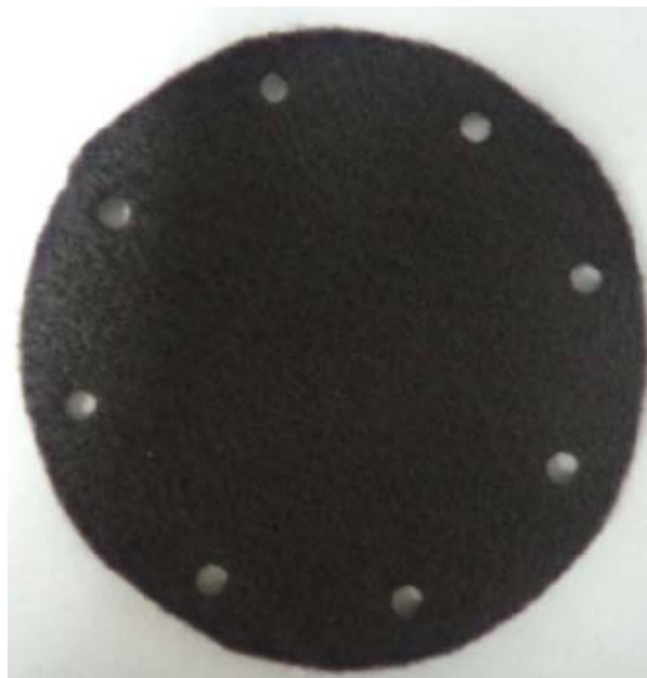
FIGURA 5.16 – Geotêxtil antes do ensaio de dano mecânico.
