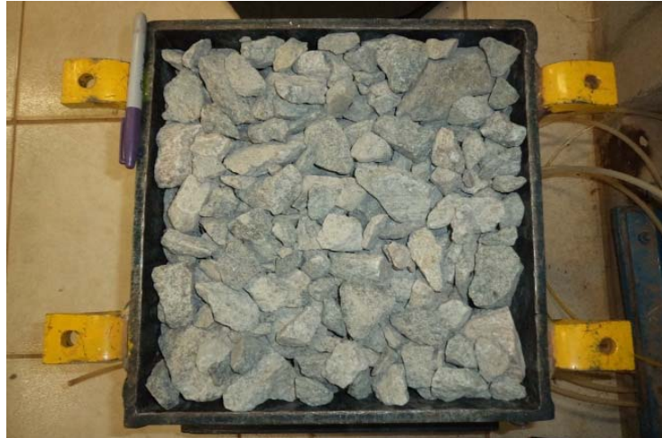
FIGURA 4.11 – Brita subjacente à geomembrana.
