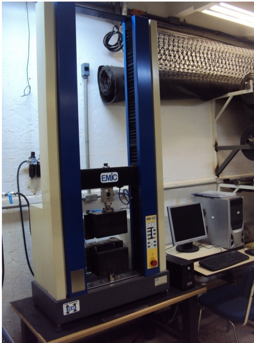
FIGURA 4.14 – Vista do equipamento de resistência à tração simples.
