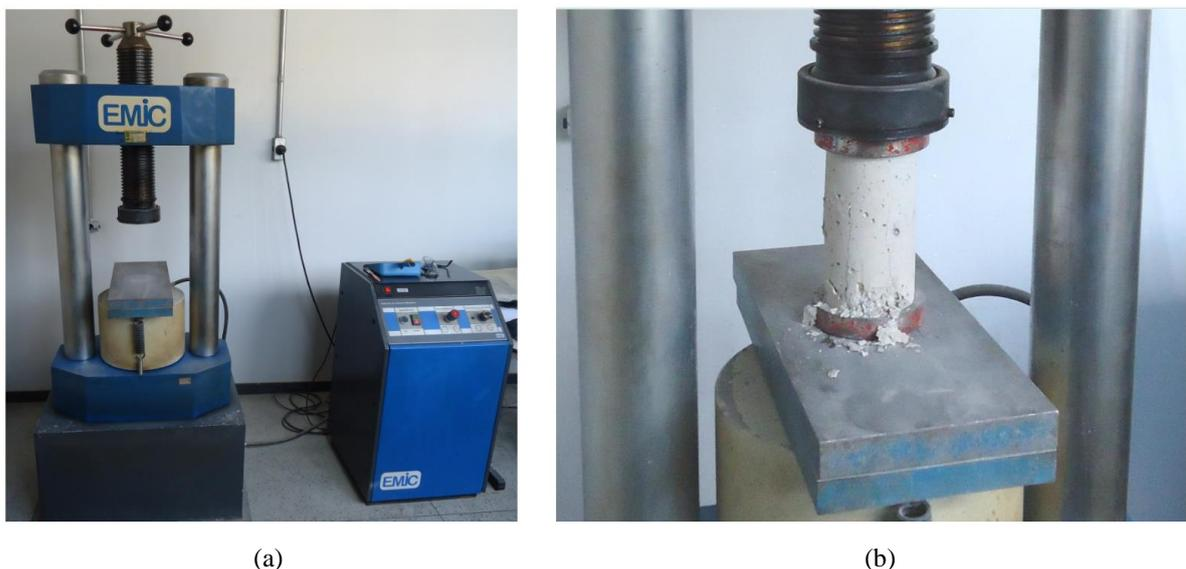
FIGURA 3.7 – Ensaio de compressão axial em corpos de prova cilíndricos de concreto: (a) ilustração do equipamento utilizado neste trabalho, (b) corpo de prova cilíndrico submetido a um carregamento centrado.
