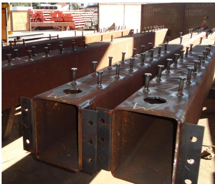
FIGURA 2.12 - Vigas mistas, utilizando *stud bolts* como conectores de cisalhamento.
