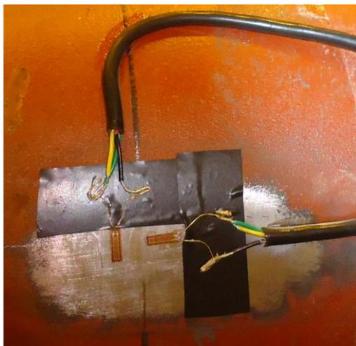
FIGURA 3.22 - EER sobre a parede do tubo de aço, dispostos nas direções longitudinal e transversal.
