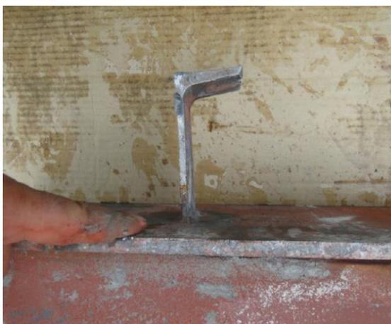
FIGURA 2.15 – Conector de cisalhamento do tipo cantoneira com abas desiguais e extremidade soldada sobre o perfil metálico (SHARIATI *et al.*, 2012b).
