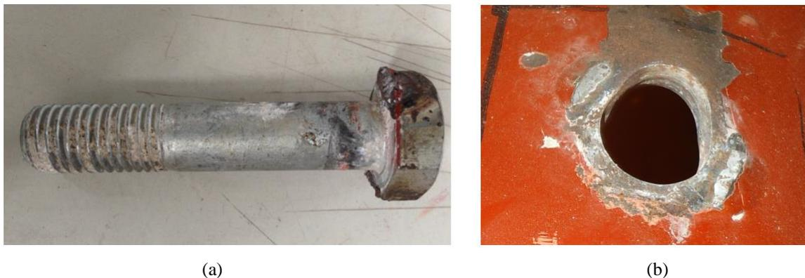
FIGURA 4.15 – Observações feitas após realização do ensaio no modelo H2: (a) praticamente nenhuma deformação permanente é observada nos parafusos, (b) esmagamento da parede do furo no tubo de aço,
