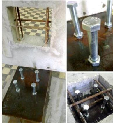
FIGURA 2.30 – Pré-montagem de ensaios de cisalhamento direto padrão utilizando parafusos como conectores de cisalhamento (PAVLOVIĆ *et al.*, 2013).
