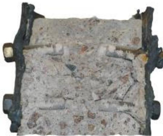
FIGURA 2.28 - Falha de um PMPC por escoamento do tubo de aço e esmagamento do concreto STAROSSEK *et al.*, 2008).
