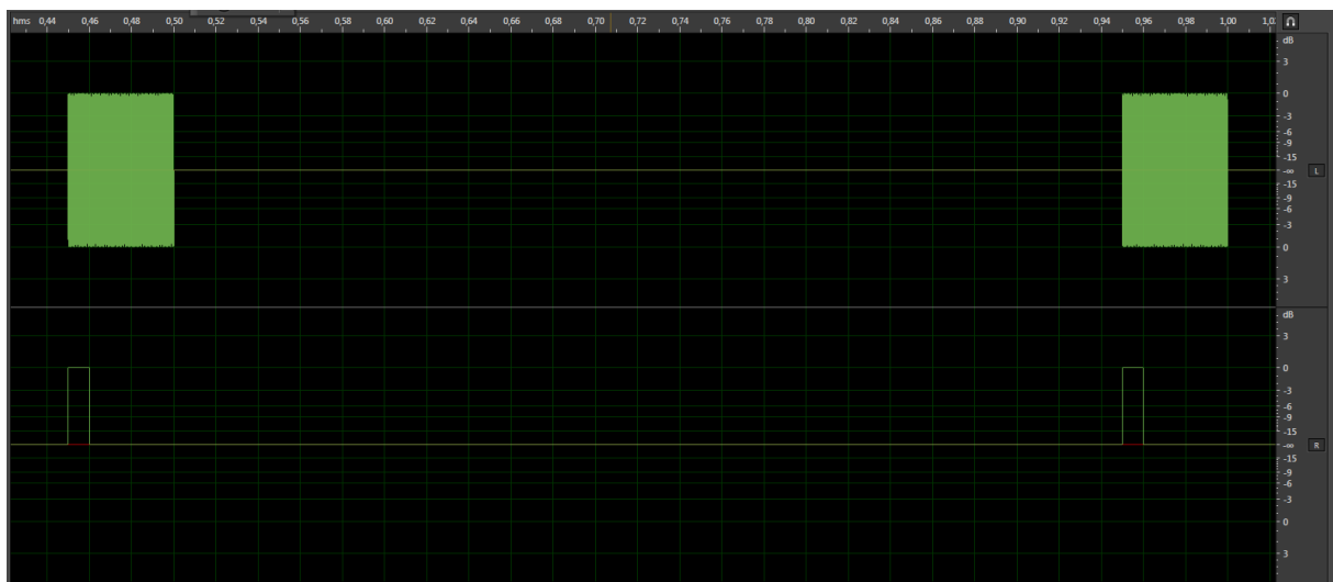
Figura 9 – Estímulo transiente para obtenção de PEAt. Janela de 600 milissegundos do software Adobe Audition 3.0. O primeiro canal (acima) é o ‘tone burst’ reproduzido pelo sistema de som; e o segundo canal (abaixo) é a onda quadrada usada como gatilho que marca o início da janela a ser recortada para a realização de médias do LFP.
