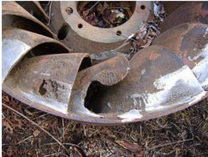
Figura 24 – Danos causados por cavitação em uma turbina Francis. Ref, Wikipédia.org. Acesso em: 21 Nov. 2014
