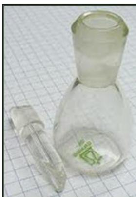
Fig. 7 – Frasco volumétrico para picnometria
