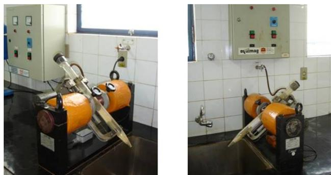
**Figura 3.27** – Concentrador eletromagnético Tubo Davis (\*).
