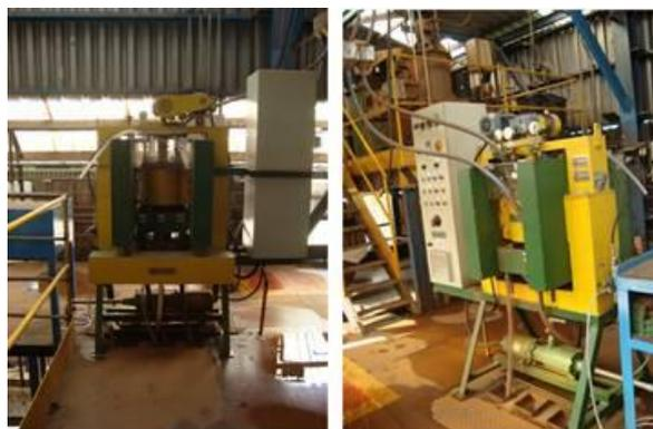
**Figura 3.31** – Concentrador eletromagnético Minimag (\*).
