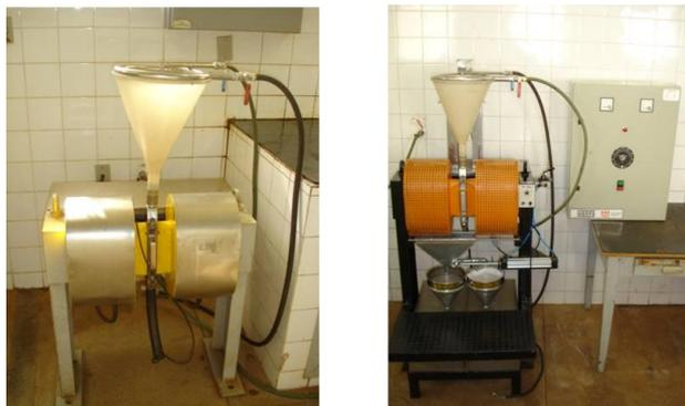
**Figura 3.28** – Concentrador eletromagnético L4 (\*).
