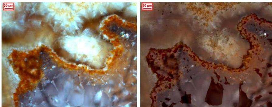
**Figura 3.17** - Fotomicrografias – microscópio ótico de luz refletida – nicóis paralelos (esquerda) e cruzados (direita). Partículas contendo gibbsita (\*).
