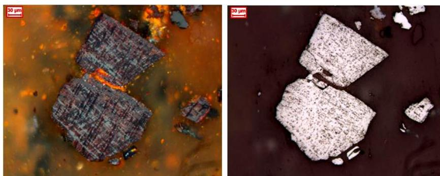
**Figura 3.12** - Fotomicrografias – microscópio ótico de luz refletida – nicóis cruzados (esquerda) e paralelos (direita). Cristais de hematita martítica (\*).
