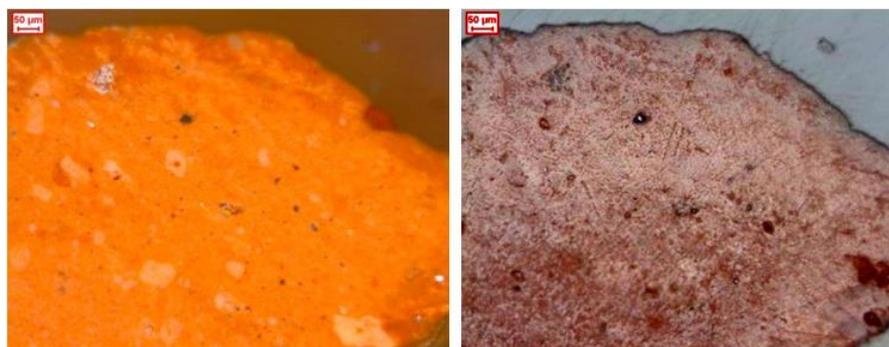
**Figura 3.15** - Fotomicrografias – microscópio ótico de luz refletida – nicoóis cruzados. Partículas contendo goethita terrosa (\*).
