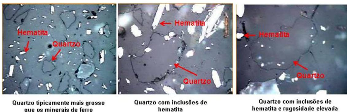
**Figura 3.24** - Características de quartzo grosso, com inclusões de óxido ferroso e rugosidade elevada (\*).
