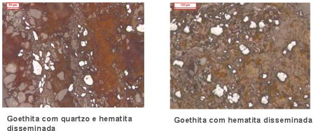
**Figura 3.25** - Minerais com porosidade elevada: goethita com disseminação de quartzo e hematita (\*).
