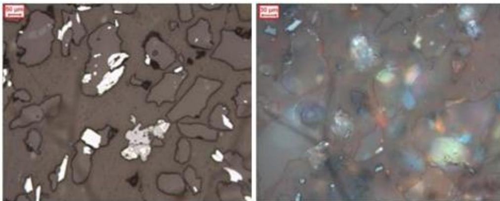
**Figura 3.16** - Fotomicrografias – microscópio ótico de luz refletida – nicóis paralelos (esquerda) e cruzados (direita). Cristais de quartzo (\*).
