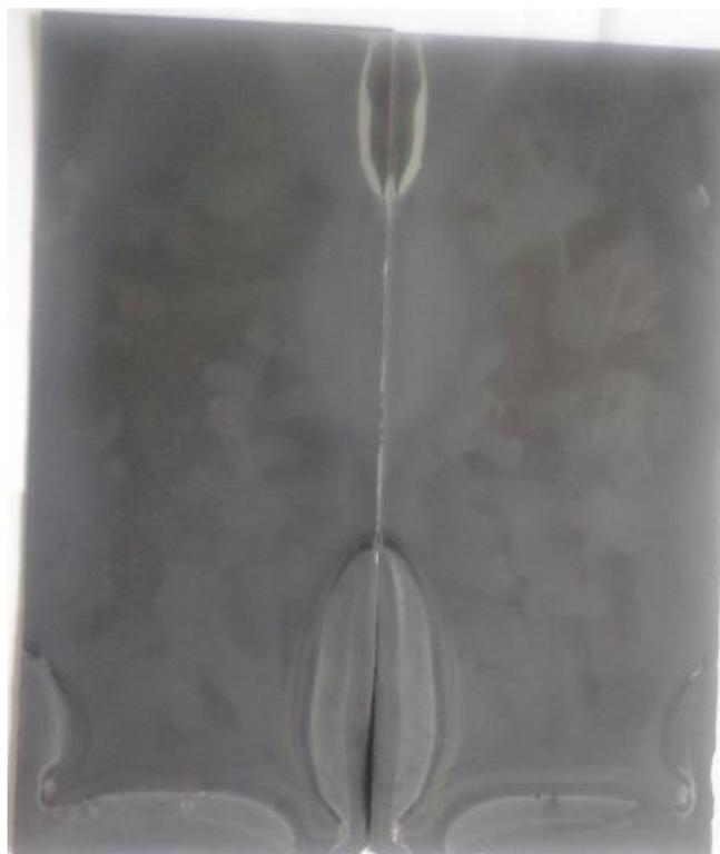
Fig 5.3: Superfície de amostras tratadas a 800 °C. Área totalmente oxidada.
