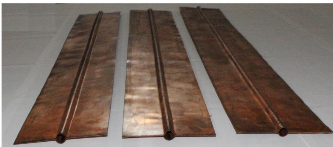
Fig 5.7: Tubos aletados de 100 mm de largura, tratado a 500 °C com aspecto uniforme para coletor solar.
