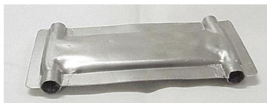
Fig 8.2: Trocador de calor em alumínio.
