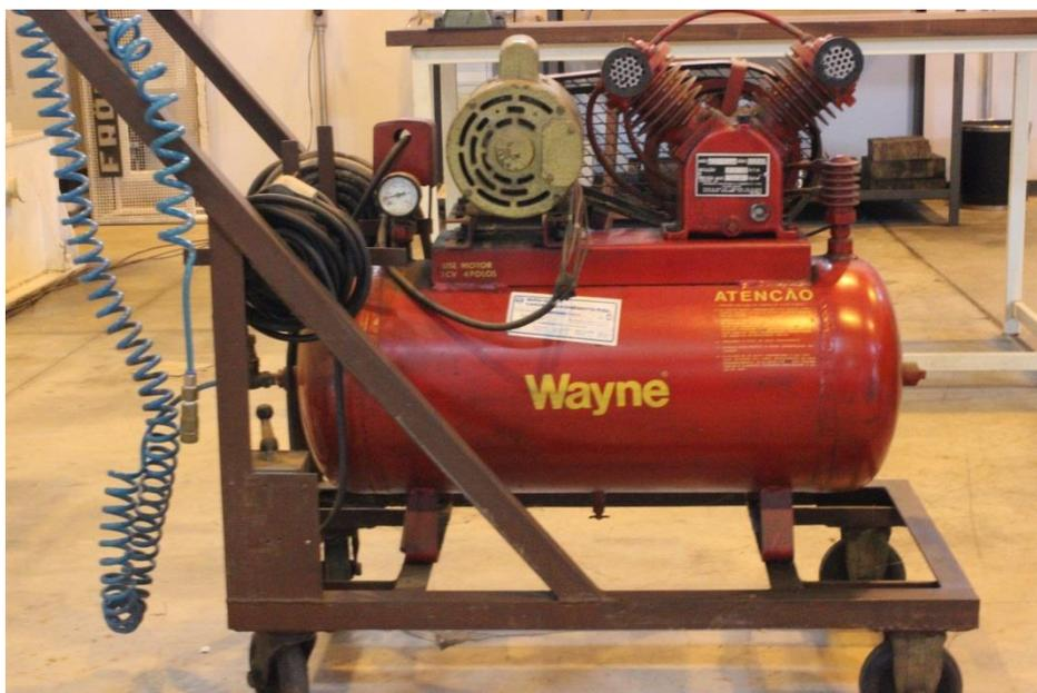
Fig 4.2.5: Compressor Wayne de pressão 8,8 MPa.
