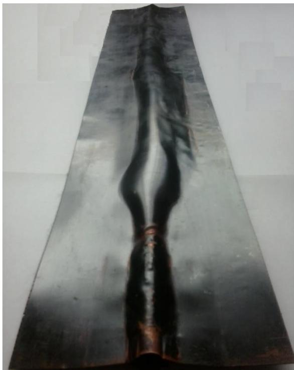
Fig 5.5: Tubo aletado de 120 mm de largura tratado a 600 °C mostrando a má formação do tubo.
