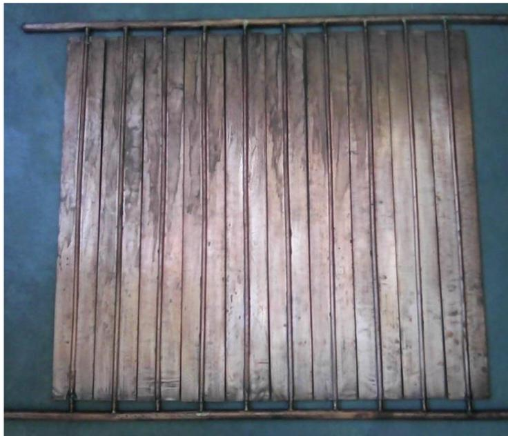
Fig 5.8: Placa absorvedora para coletor solar feita de dez tubos aletados.
