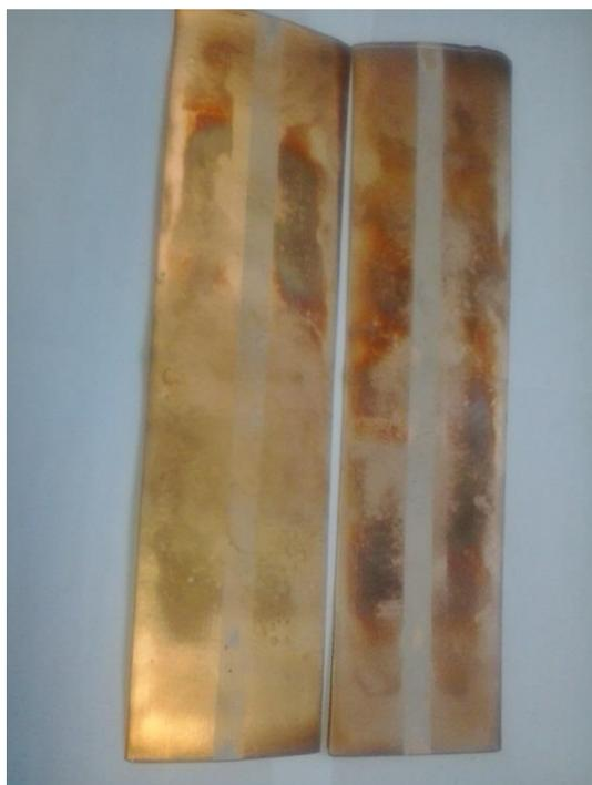
Fig. 5.4: Tira de cobre de 100 mm de largura colaminadas tratadas a 600 ou 800 °C não unidas devido ao encruamento.
