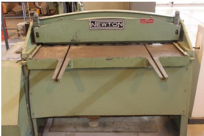
Fig 4.2.1: Guilhotina de chapa Newton com capacidade máxima de corte de  $8,2 \times 10^6$  MPa.
