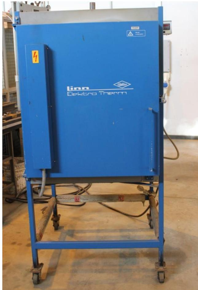
Fig 4.2.4: Forno Linn de potência máxima de 18 kW.
