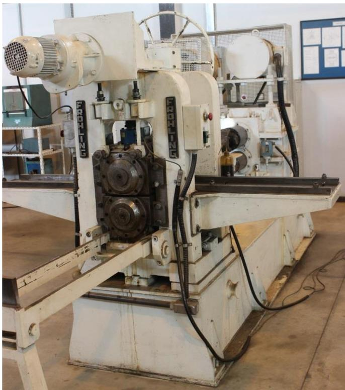
Fig 4.2.3: Laminador Fröhling com capacidade de carga de 392,27 kN.
