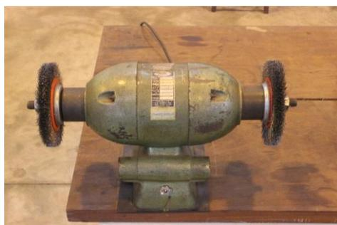
Fig 4.2.2: Escova rotativa HW de 2950 rpm.
