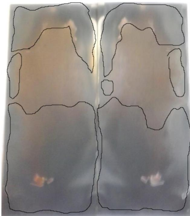
Fig 5.2: Superfície de amostras tratadas a 600 °C. Áreas contornadas mostram áreas de oxidação.
