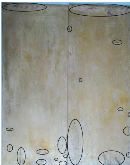
Fig 5.1: Superfície de amostras tratadas a 500 °C. Círculos indicam pontos de oxidação.
