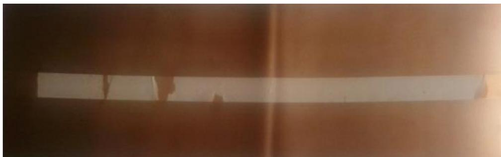
Fig 5.11: Papel de seda1 de 0,01 mm de espessura rasgado de uma amostra onde não houve união em fase sólida.
