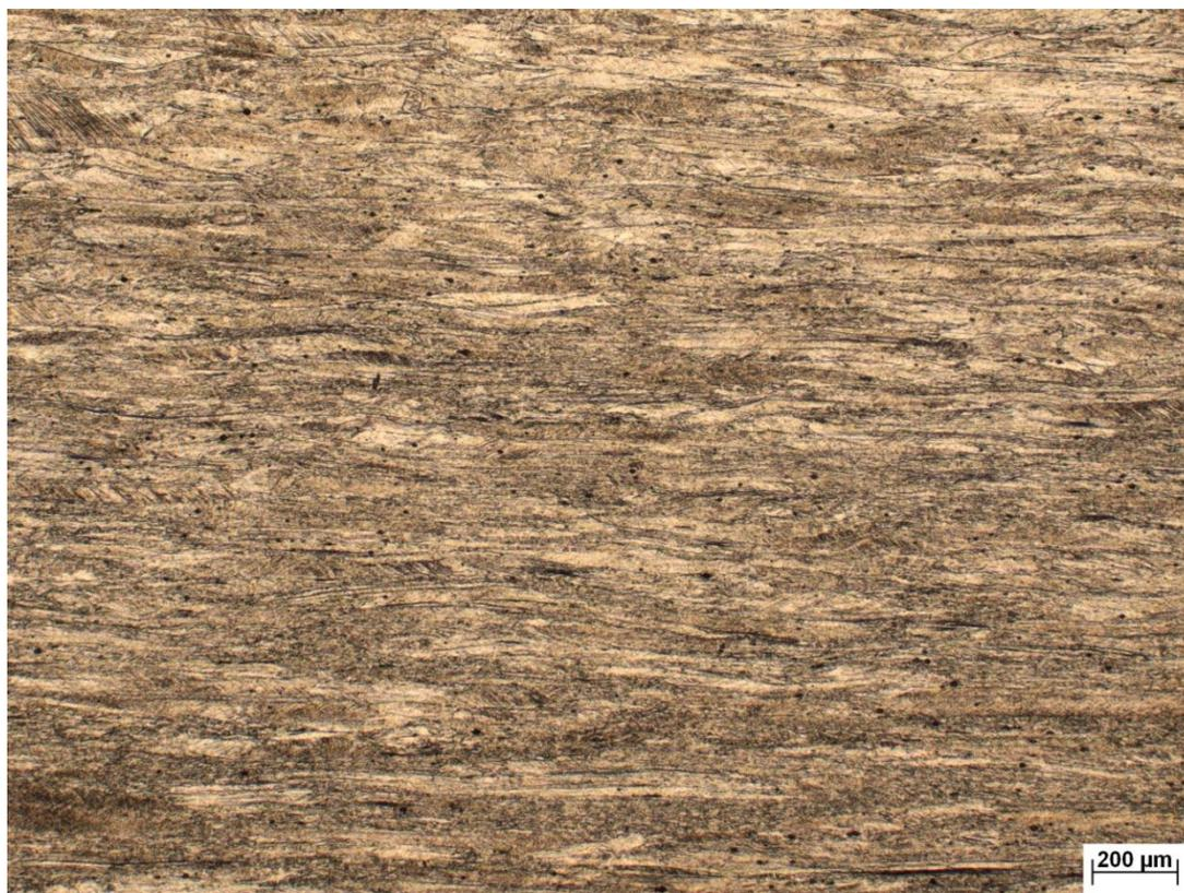
Figura 5.14 – Aspecto microestrutural da amostra, observado via microscopia óptica, após simulação da etapa de laminação a frio piloto, com 60% de redução na espessura.
