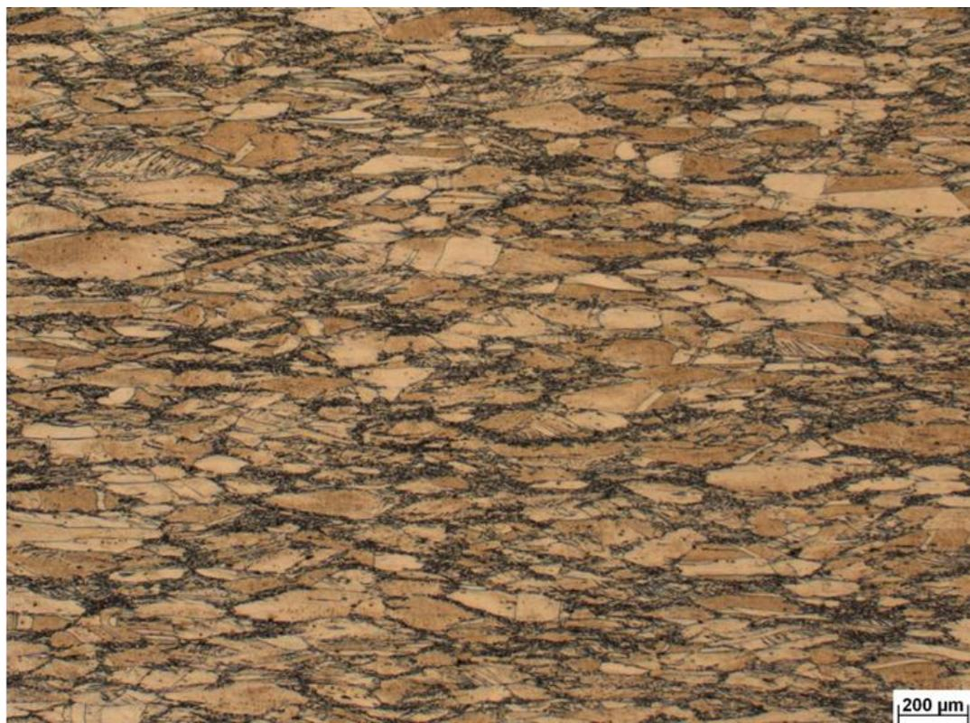
Figura 5.12 – Aspecto microestrutural da amostra, observado via microscopia óptica, após a etapa de laminação piloto a quente.
