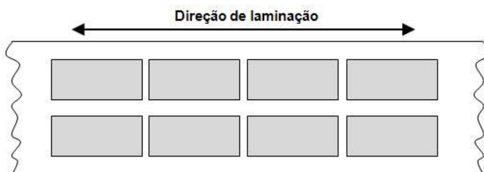
Figura 4.6 – Esquema representativo dos locais onde foram retiradas as amostras para as simulações térmicas na máquina Gleeble.
