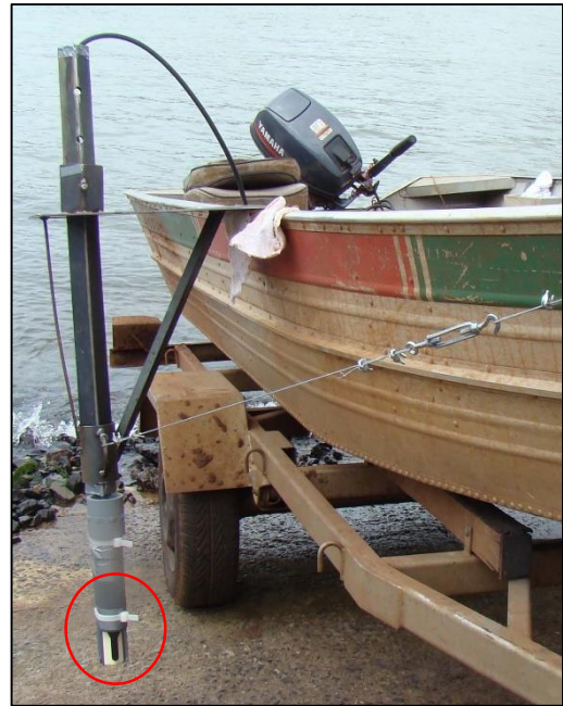
Figura 3.5. Suporte do hidrofone (círculo vermelho) utilizado no rastreamento móvel de barbados e caranhas no baixo rio Paranaíba entre outubro de 2012 e fevereiro de 2014.
