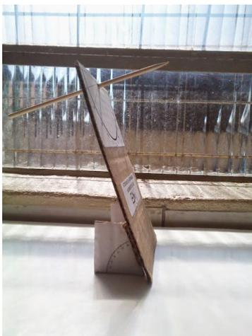
**Fig. 13 – Vista lateral do Relógio de Sol. Com destaque para a sua inclinação que corresponde aproximadamente ao complemento da latitude da Cidade de Contagem.**
