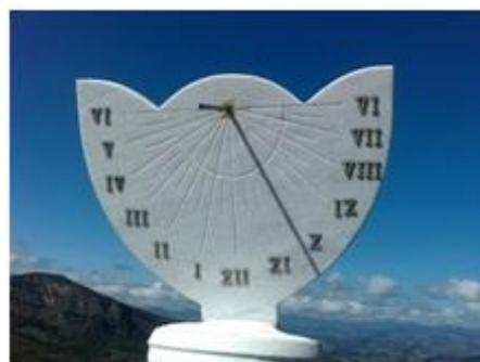
**Fig. 10 - Relógio de Sol Equatorial. A sombra sobre a marcação mostra a hora solar local.**
