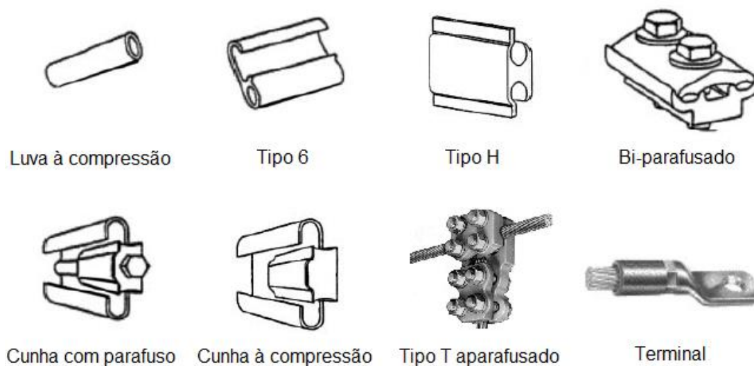
Figura 4.2 – Exemplos de conectores por pressão (Adaptado de: BRAUNOVIC, 2006).
