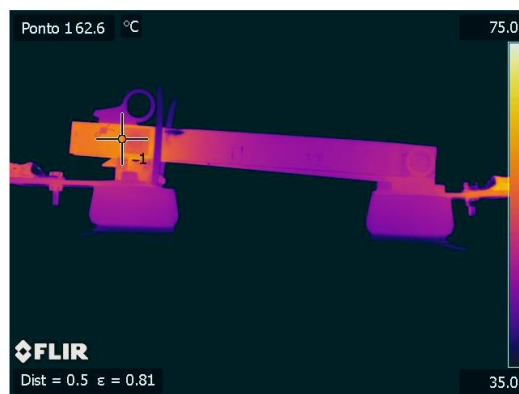
Figura 6.36 – Imagem radiográfica utilizada para diagnóstico da seccionadora.
