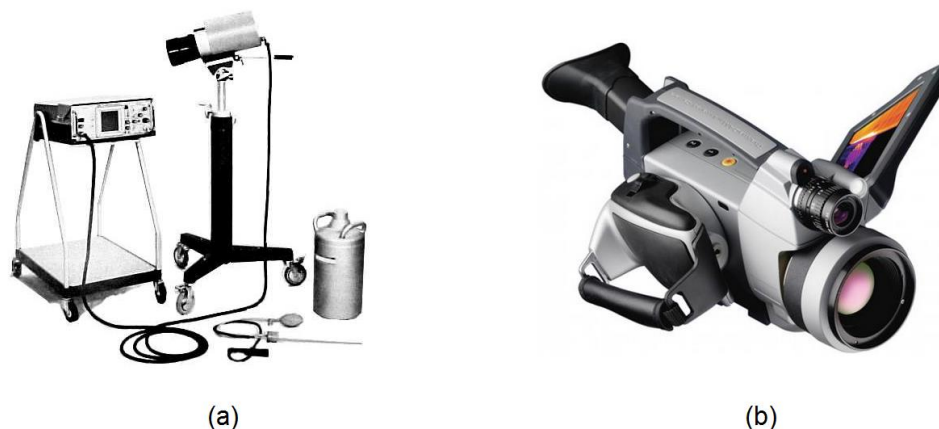
Figura 3.2 – Evolução dos termovisores: (a) Detector AGA 680 resfriado a nitrogênio líquido e sistema de varredura óptico/mecânico, peso total de 37 kg. (b) Termovisor modelo FLIR SC660, peso total de 1,7 kg. (Fonte: ARAÚJO, 2008; FLIR Commercial Systems, www.flir.com acesso em 23/12/2014).
