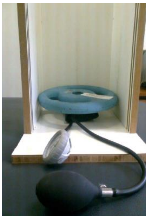
FIGURA 2 – Calibração do esfigmomanômetro modificado utilizando aparato de madeira
