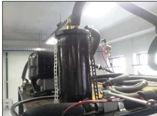
FIGURA 3.7 - Acumulador da bomba de calor
