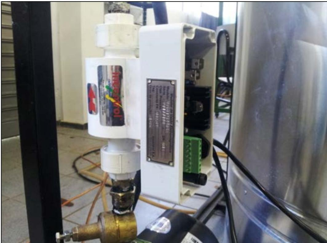
FIGURA 3.10 - Medidor de vazão eletromagnético VMS PRO
