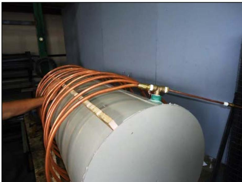
FIGURA 3.4 - Condensador / Resfriador da bomba de calor
