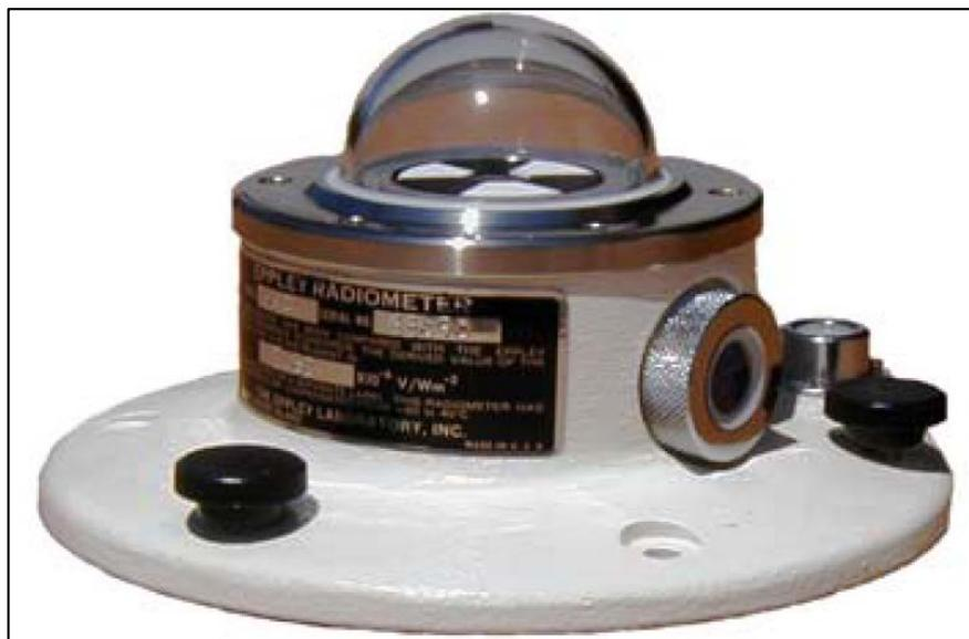
FIGURA 3.13 - Sensor de radiação solar
