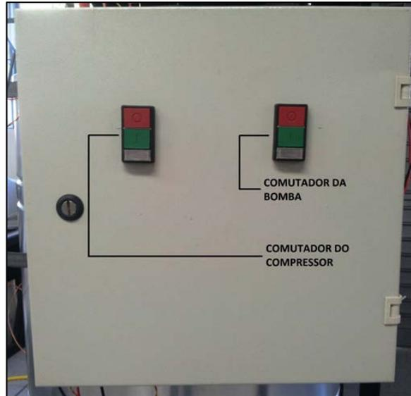
FIGURA 3.6 - Indicação dos comutadores no Painel de Controle
