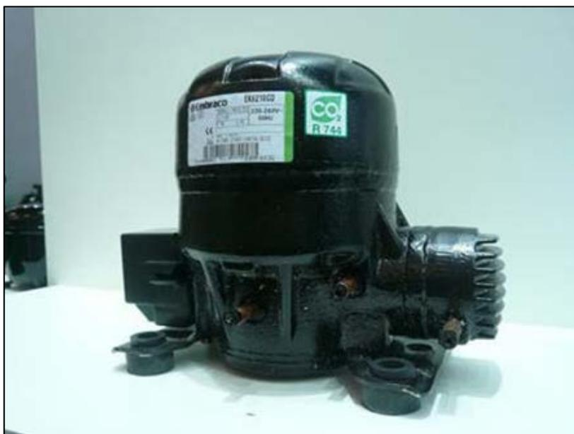
FIGURA 3.3 - Compressor da bomba de calor
