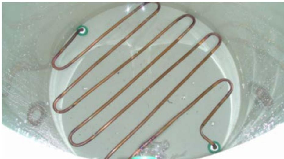
FIGURA 3.9 – Condensador dentro do reservatório.
