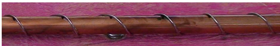
FIGURA 3.11 – Resistência elétrica enrolada no tubo de cobre do coletor solar para simular o efeito termossifão.
