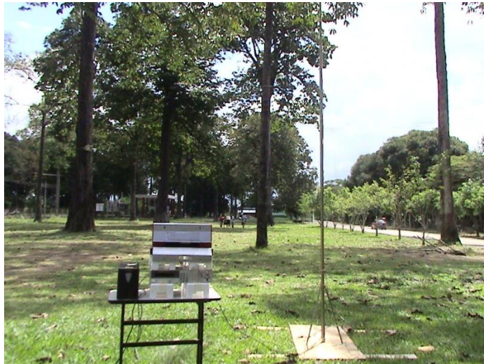
Figura C.3.3: Foto do cenário mostrando em primeiro plano o módulo T_x e ao fundo a equipe fazendo a medição no módulo R_x .
