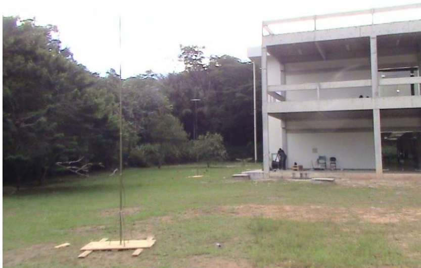
Figura C.2.1: Foto das torres dos módulos T_x e R_x , com antenas log-periódicas, estruturas estaiadas, montadas sobre plataforma em madeira.
