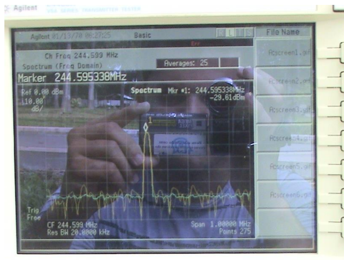
Figura C.3.6: Foto do aluno Reury Matias fotografando a tela do Analisador de Espectro que apresenta a imagem da onda portadora sintonizada na frequência f_2=244,599 MHz.
