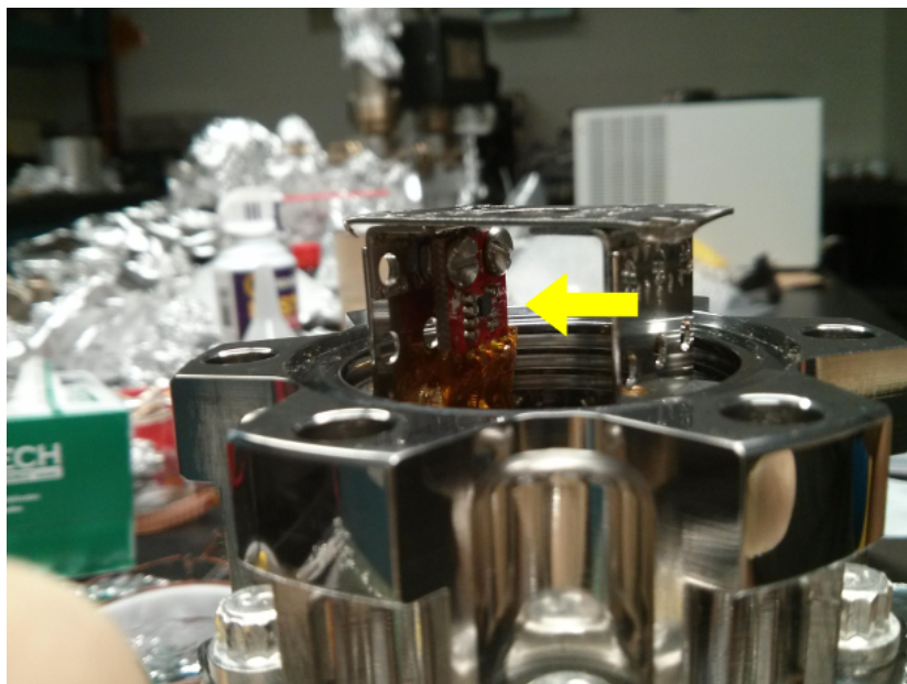
FIGURA 5.18: Magnetômetro introduzido logo abaixo da cavidade. A seta amarela mostra o magnetômetro introduzido para medir o campo magnético perto da cavidade.
