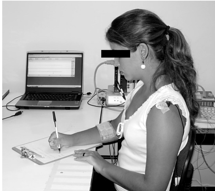
FIGURA 38 – Posicionamento dos eletrodos de superfície e do eletrodo terra
