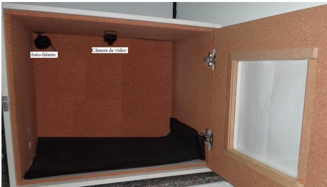
Figura 9 – Foto do interior da caixa de isolamento acústico, contendo alto-falante e câmera de vídeo. Caixa de isolamento acústico 58x42x46 (cm), marca Insight equipamentos. Alto-falante retirado do repelente RP1000 e câmera de vídeo HDL, modelo HM21/2004.
