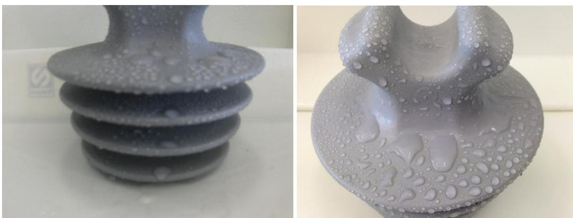
**Figura VII.3:** Imagens da amostra A3 após ensaio de hidrofobicidade, antes (esquerda) e após (direita) envelhecimento acelerado.
