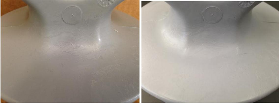
**Figura VI.4:** Imagem da amostra A4 antes (esquerda) e após (direita) envelhecimento.
