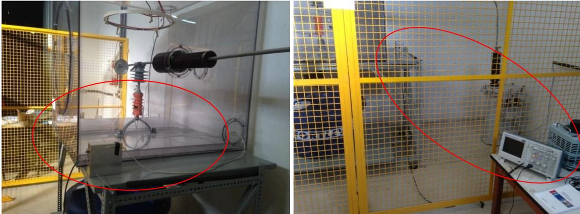
**Figura 52:** Fotografias da montagem do sistema de medida de corrente de fuga.
