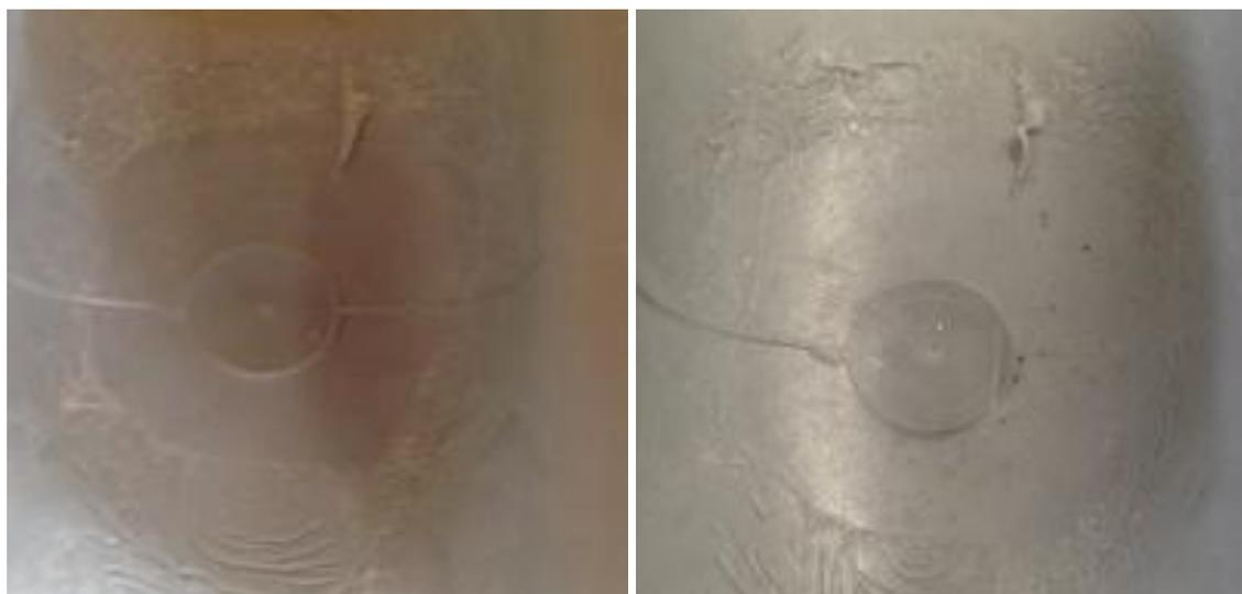
**Figura 53:** Fotografias indicando detalhes do centro do topo do isolador antes (esquerda) e após (direita) envelhecimento da amostra A5E1.
