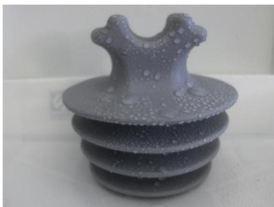
**Figura VII.6:** Imagens da amostra A6 após ensaio de hidrofobicidade, antes do envelhecimento acelerado.
