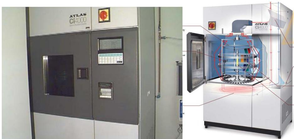
Figura III.3: Fotografia do equipamento de envelhecimento artificial acelerado na etapa 3.
