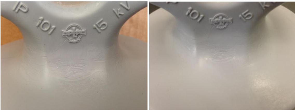
**Figura VI.5:** Imagem da amostra A5 antes (esquerda) e após (direita) envelhecimento.
