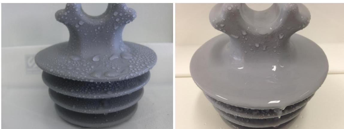
**Figura VII.5:** Imagens da amostra A5 após ensaio de hidrofobicidade, antes (esquerda) e após (direita) envelhecimento acelerado.
