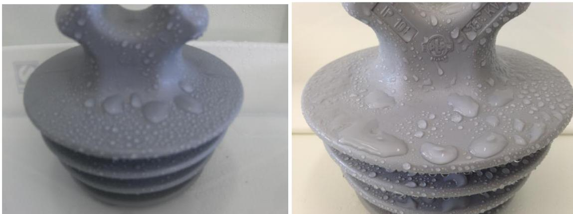
**Figura VII.4:** Imagens da amostra A4 após ensaio de hidrofobicidade, antes (esquerda) e após (direita) envelhecimento acelerado.
