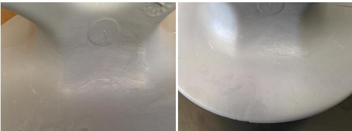
**Figura VI.3:** Imagem da amostra A3 antes (esquerda) e após (direita) envelhecimento.
