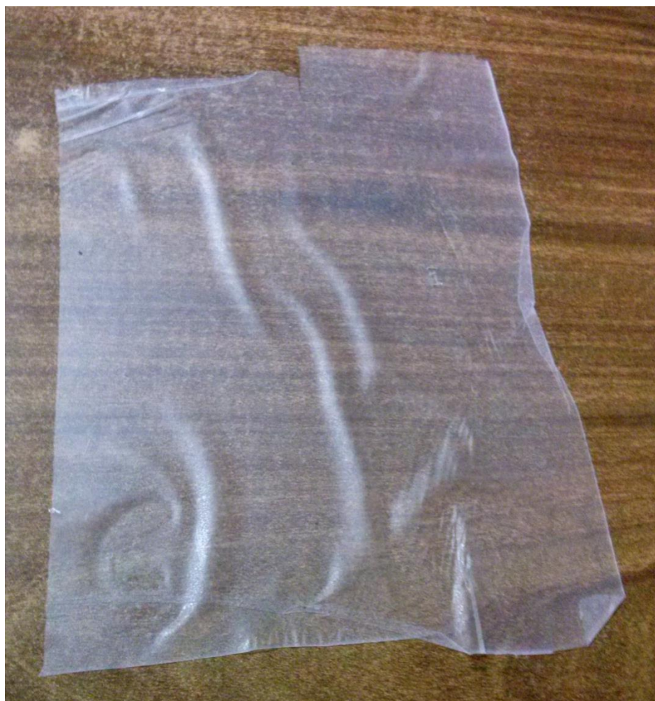
Figura 22: Imagem da membrana de PDMS sem carga.
