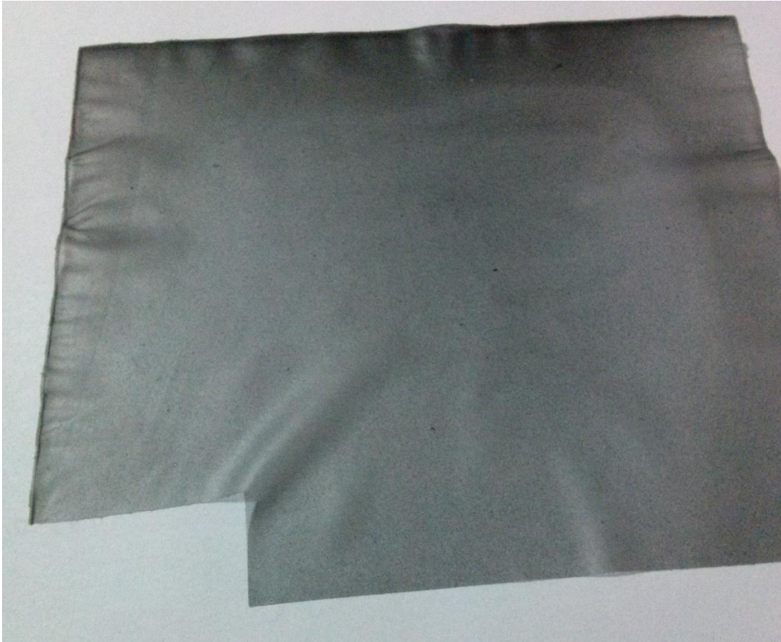
Figura 23: Imagem da membrana de PDMS com 0,5% de carvão ativado, em massa.
