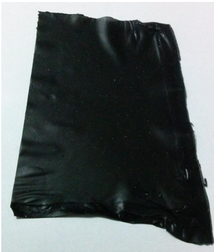
Figura 25: Imagem da membrana de PDMS com 2% de carvão ativado, em massa.
