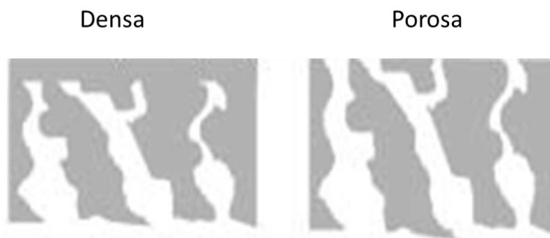
Figura 9: Esquema de morfologias de membrana anisotrópicas comerciais, seção transversal. Adaptado de HABERT et al. (2006).
