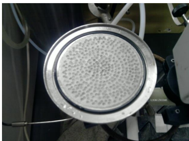
Figura 19 – Célula de permeação dos testes de pervaporação.
