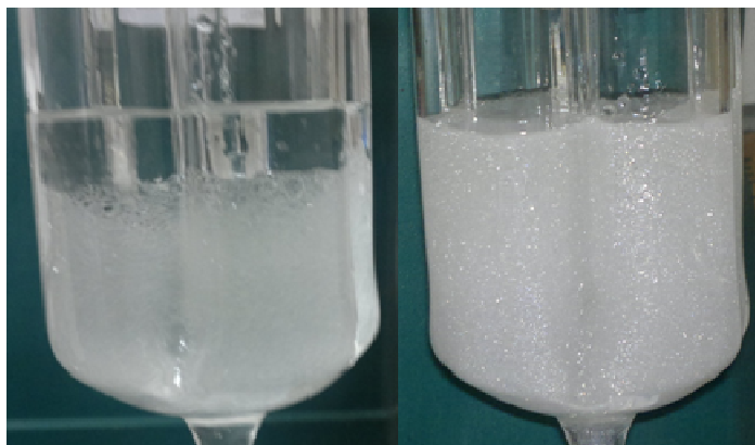
Figura 9 – Reator com água e Escaid™110 sendo agitado com uma frequência inferior a 522 rpm, à esquerda, e com velocidade de 522 rpm, à direita
