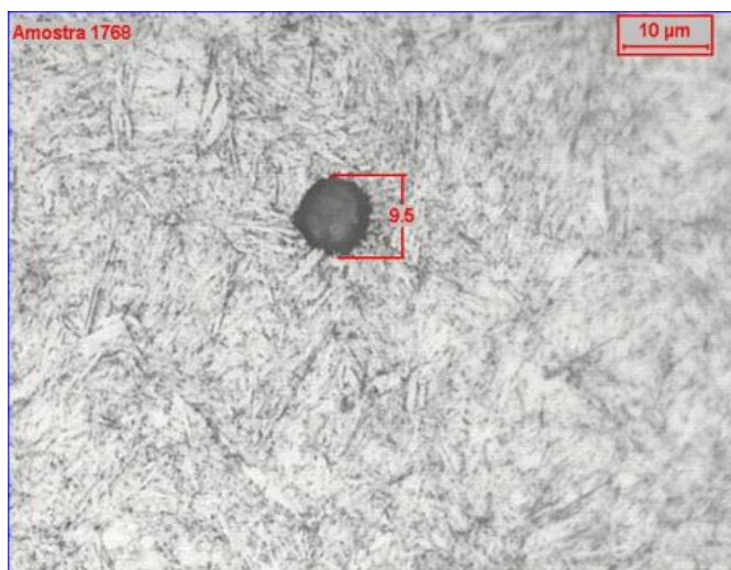
Figura 5.9 – Microestrutura do cilindro 02. Aumento de 1000x para medição do tamanho medio da inclusão.
