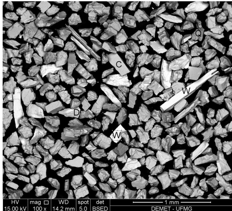
**Figura 5.6:** Micrografia em MEV mostrando partícula com aumento de 100x da faixa -150 +106  $\mu\text{m}$  mostrando o hábito acicular da wollastonita. W corresponde a wollastonita, C, calcita, D, diopsídio e Q, quartzo.
