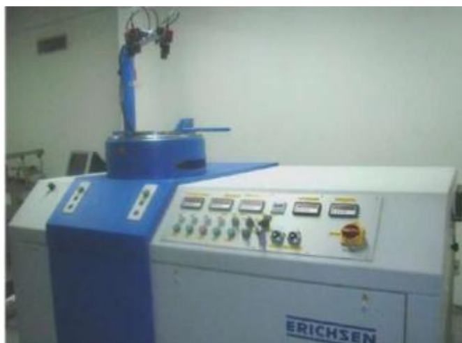
Figura 4.11 – Foto do equipamento ERICHSEN da Usiminas
