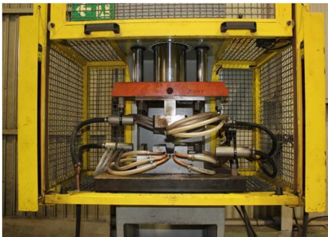
Figura 4.9 – Ferramental construído e montado na prensa hidráulica.
