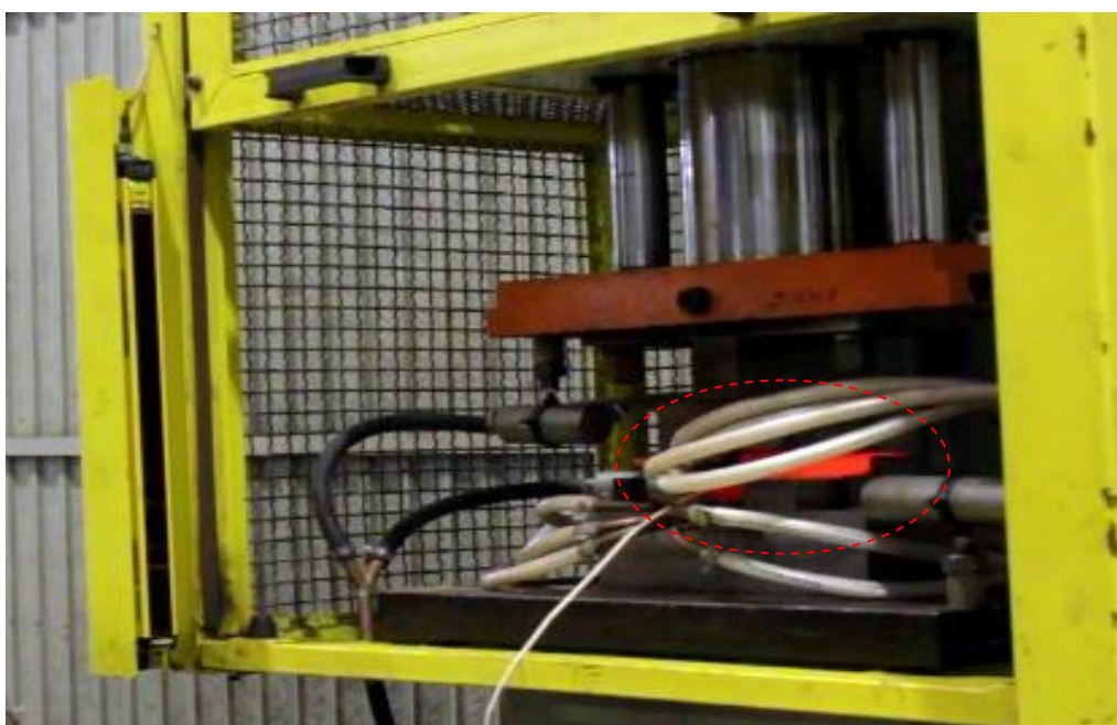
Figura 4.13 – Início do processo de conformação (em detalhe o momento em que o punção toca o corpo de prova em estudo).
