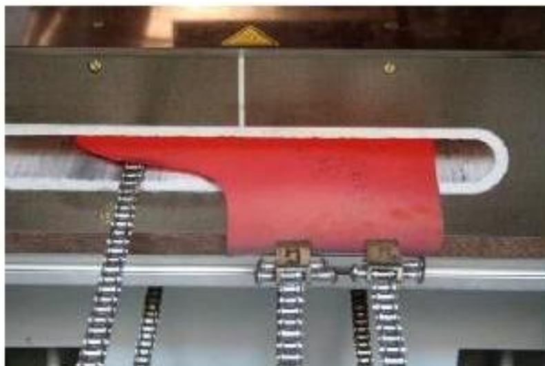
Figura 3.4 – Sistema de movimentação da peça no forno de aquecimento por indução (Kolleck et al. 2009).
