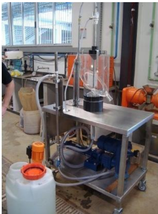
Figura 4.1 - Célula de flotação utilizada para a realização dos testes piloto
