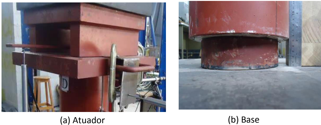
FIGURA 4.21 – Condições de contorno na base e no topo dos protótipos.
