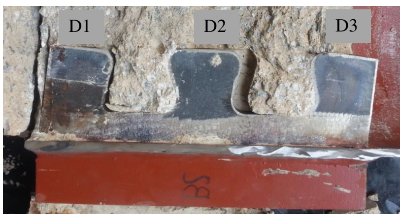
FIGURA 3.11 – Deformação de um Crestbond da Série B ao final do ensaio.
