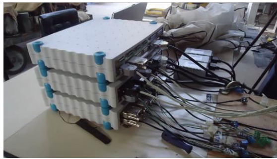
(b) Cabos e central de aquisição Spider 8
