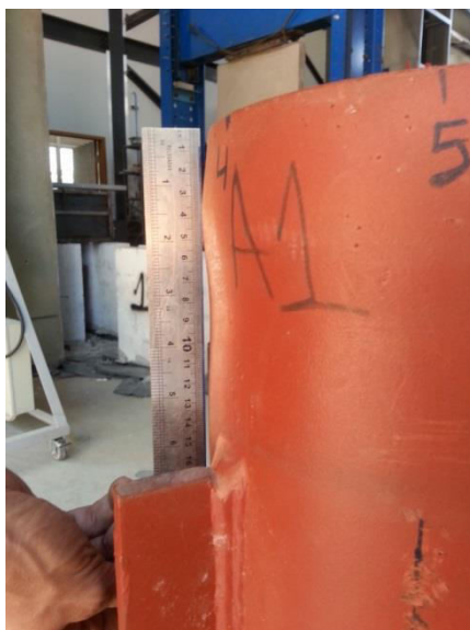
FIGURA 3.19 – Enrugamento decorrente do escoamento no topo do tubo da Série A.
