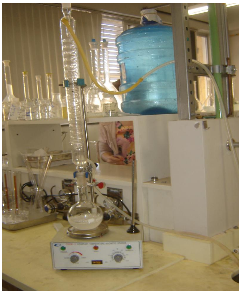
Figura A4: Montagem para saponificação em temperatura alta, com refluxo.
