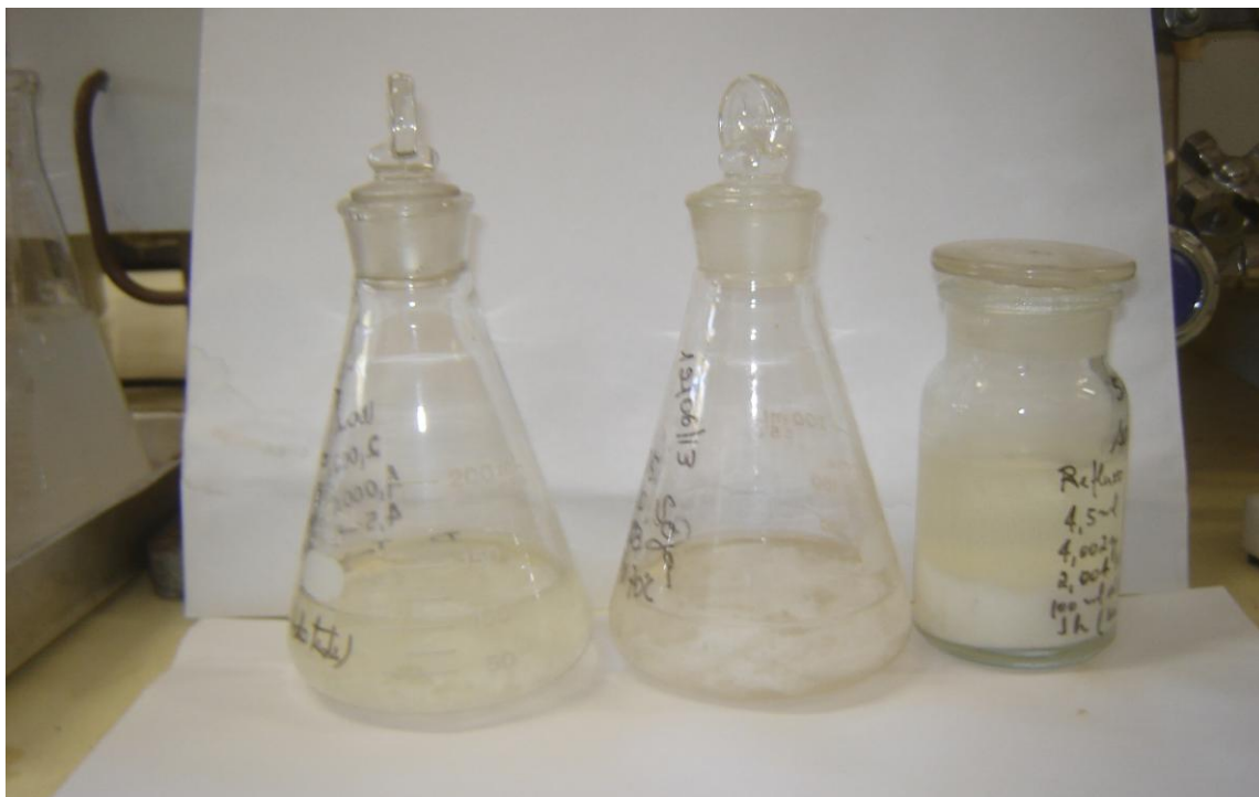
Figura A5: Amostras saponificadas: temperatura ambiente e refluxo.
