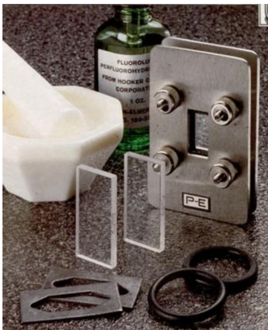
Figura 6: Célula desmontável, com janelas e juntas de vedação. Também vêm-se gral de ágata e pistilo.
