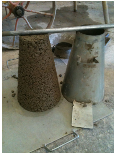
Figura 5.4 – Abatimento de tronco de cone “Slump” do concreto de referência.
