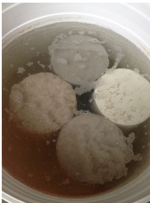
Figura 5.10 – Corpos de prova 10x20cm imersos em solução de ácido sulfúrico ( H_2SO_4 ) a 2,5%.
