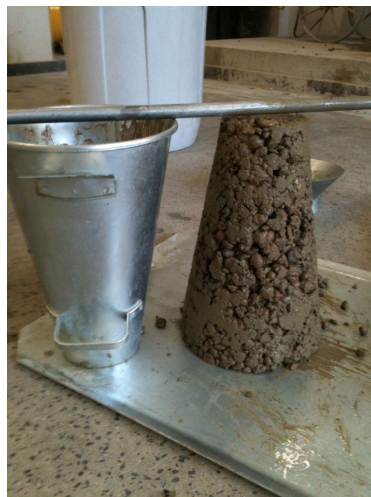
Figura 5.5 – Abatimento de tronco de cone “Slump” do concreto leve.
