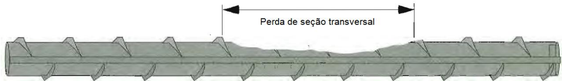
Figura 3-8 – Perda de seção transversal nas armaduras devido à corrosão. (Fonte: Emmons, 1994 – adaptado).
