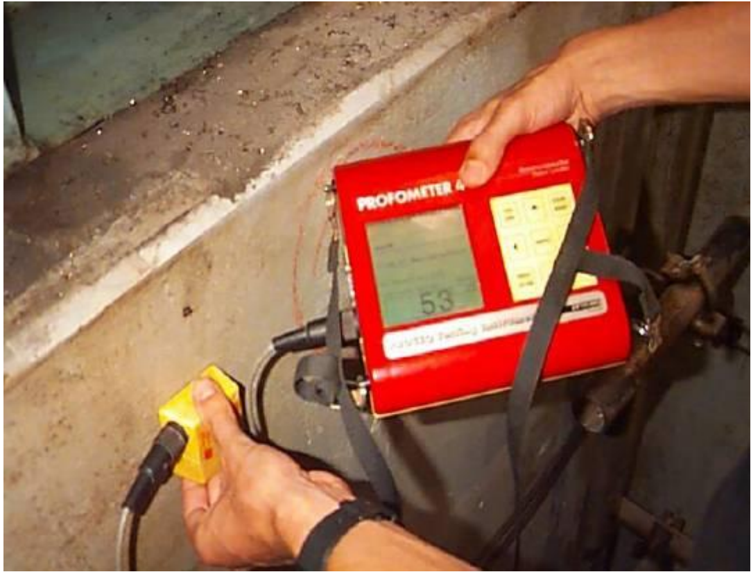
Figura 4-17 – Localização de armaduras e determinação de cobrimento através de aparelhos magnéticos. (Fonte: Aguiar, 2014).
