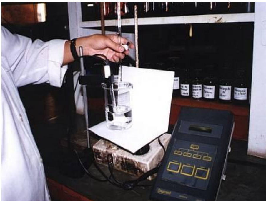
Figura 4-15 – Ensaio de teor de cloretos sendo realizado em laboratório. (Fonte: Aguiar, 2014).
