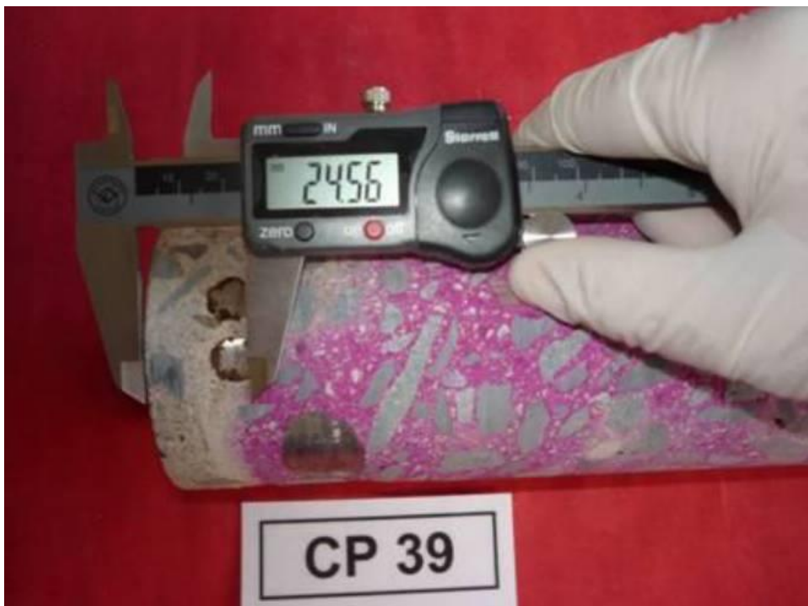
Figura 4-12 – Ensaio de profundidade de carbonatação. (Fonte: Aguiar, 2014).
