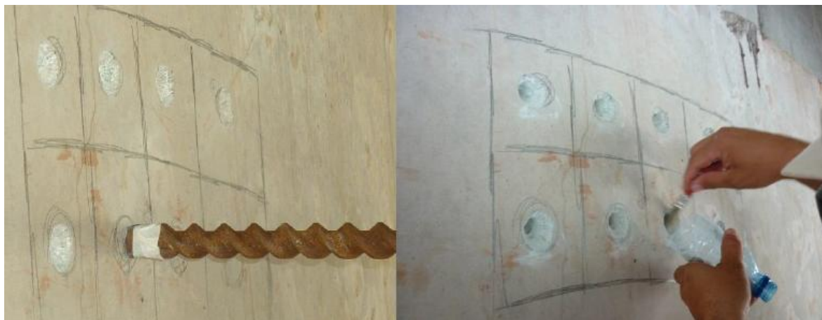
Figura 4-14 – Obtenção do perfil de cloretos em diferentes profundidades em uma peça de concreto. (Fonte: Aguiar, 2014).
