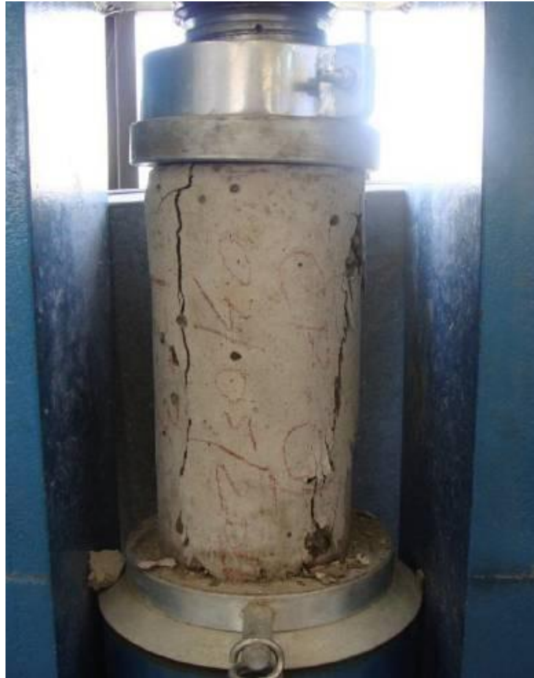
Figura 4-9 – Ensaio de compressão axial. (Fonte: Aguiar, 2014).
