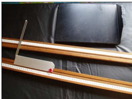
FOTOGRAFIA 2: Medida da altura de um voluntário com uso antropômetro portátil e fotografia do equipamento utilizado.
